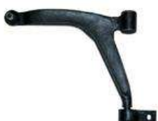
FT15681 BRAS DE LIAISON, SUSPENSION DE ROUE ESSIEU AVANT G HDI 18MM
